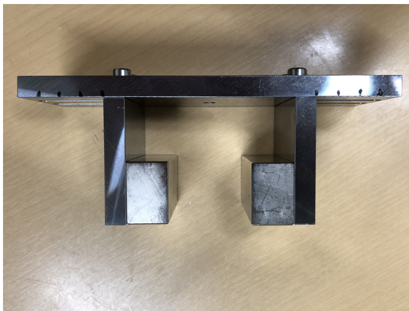
図 3.16 作成した磁気回路
