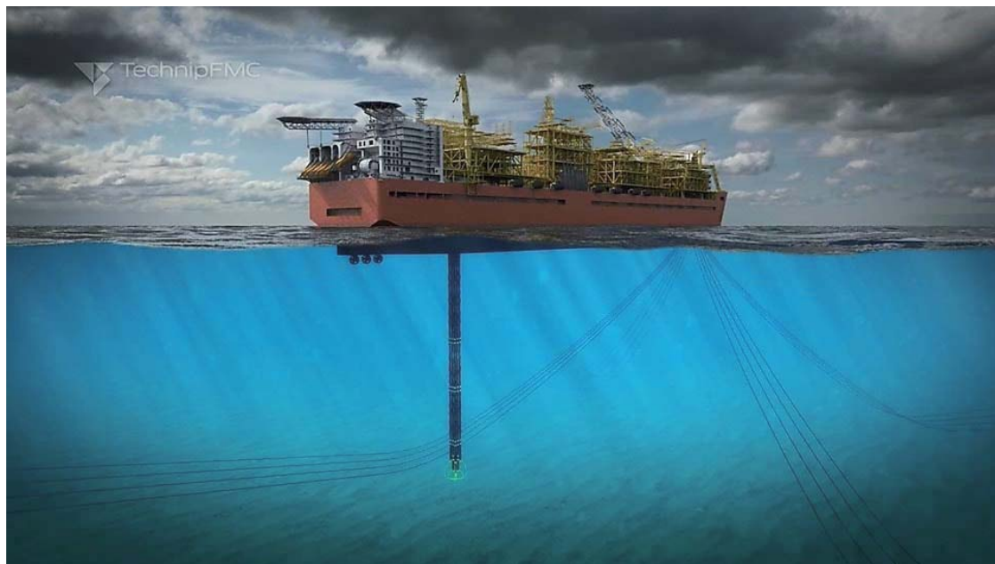
Fig. 1. 2 Prelude の取水用ライザー [10]
