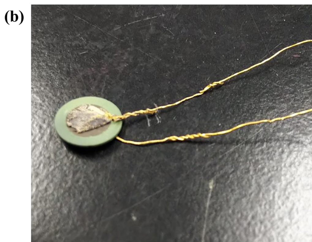
図 6.1 (a)アノード支持型セルの模式図、(b)測定前のアノード支持型セル。
