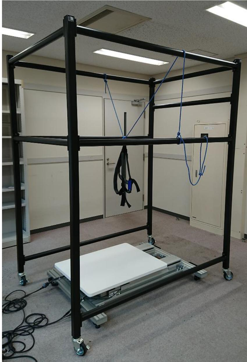
図 4.4 スライドテーブルと転倒防止装置。スライドテーブルの上に被験者を立たせ、テーブルを水平に移動させることで外からの力とする。転倒を防止するため、被験者は転倒防止装置と紐でつながったハーネスを装着する。
