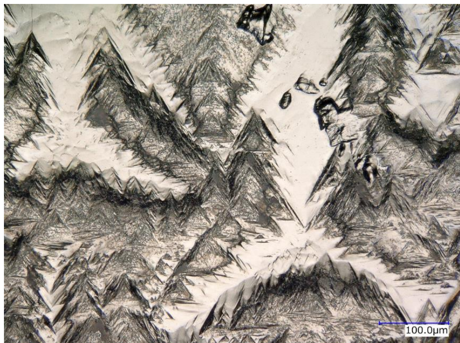
Fig. 3-6 後期に成長した結晶の硝酸エッチング後の(111)面
