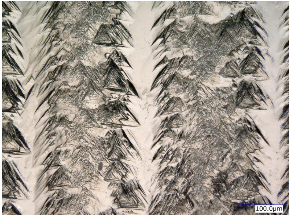
Fig. 3-5 初期に成長した結晶の硝酸エッチング後の(111)面
