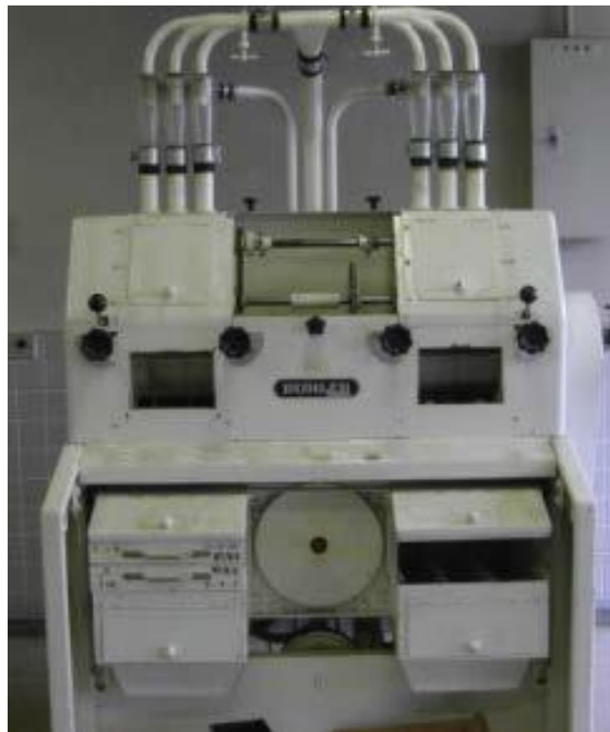
図 3-1 Bühler 社製のラボラトリーミル MLU-202
