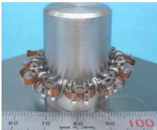
図 4.28 10 台連結スキッドステア方式マイクロロボット
