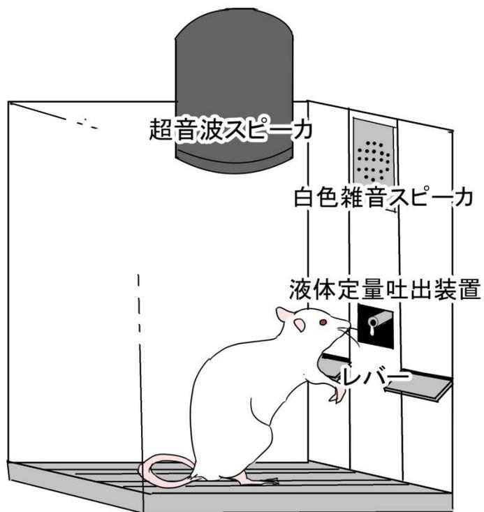
図4 オペラント装置の概要図
