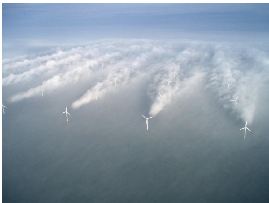
Figure 1-11 : Horns Rev 洋上ウインドファームにおける後流の様子 [14]
