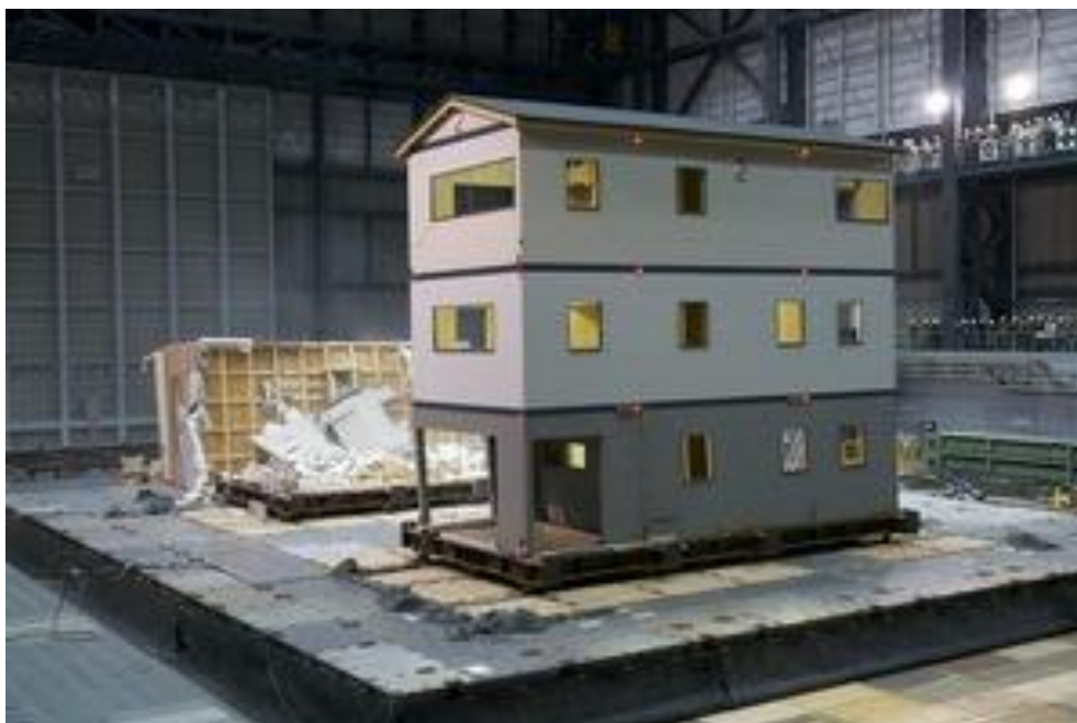
図 2.2.1 長期優良住宅の倒壊（図 1.1.2 再掲）
