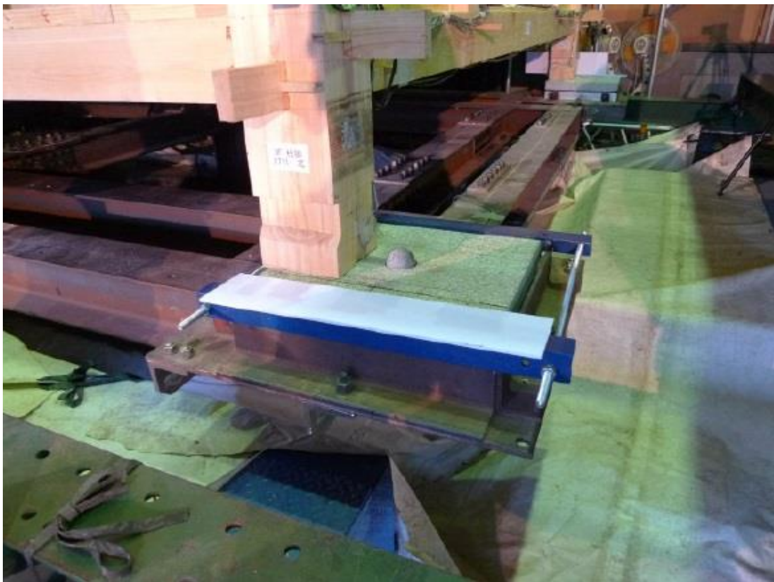
図 2.6.3 JMA 神戸波加振でのダボ飛び越え（写真：文献 24 から一部引用）
