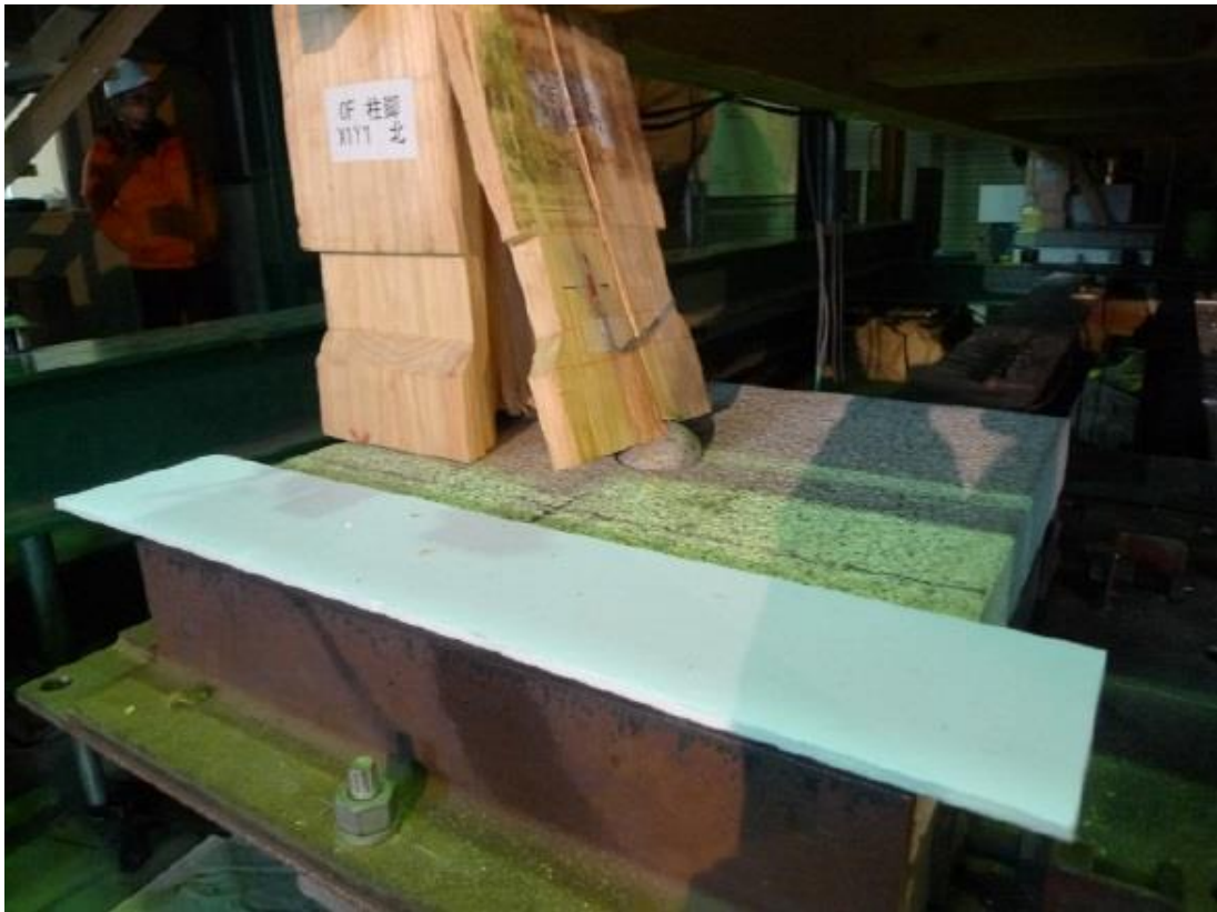
図 2.6.2 JMA 神戸波加振での柱脚割裂（写真：文献 24 から一部引用）
