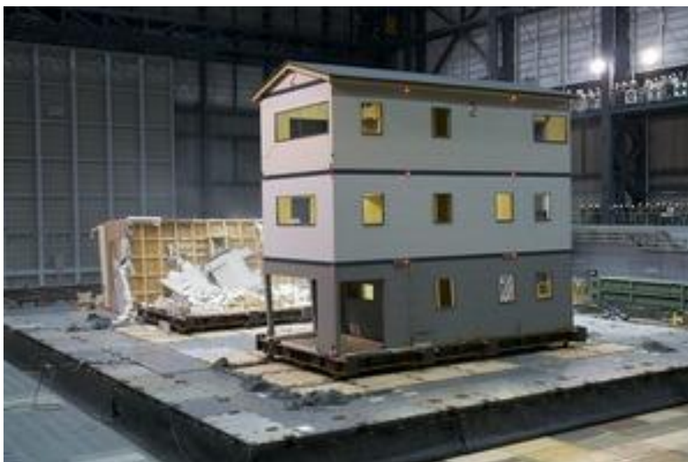
図 1.1.2 長期優良住宅の倒壊（写真：文献 5) から一部引用）
