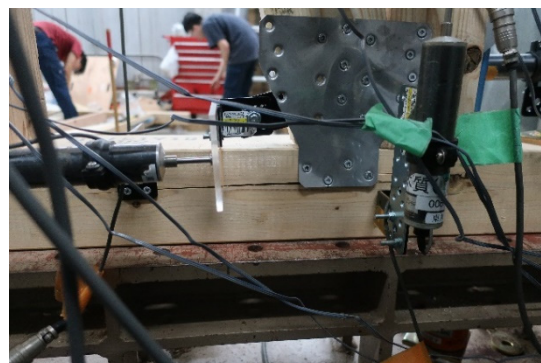
(c) 土台の割裂破壊 (NLS-2R)
