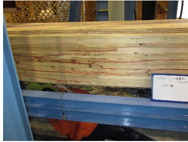
(2) SSP_BS-1 ウェブの曲げ破壊
