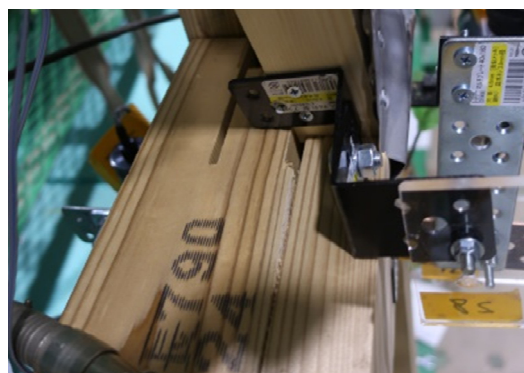
(b) 中間横架材接合金物スリット部の圧縮筋かい によるタテ割裂破壊 (NHD-2)
