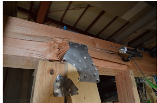
(b) 圧縮筋かいによる梁のめり込み破壊 (NLS-2)
