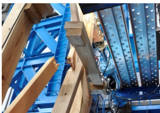
(a) 上段圧縮側筋かいの座屈破壊 (HD-1)
