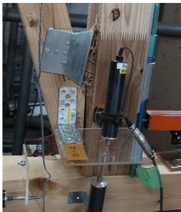
(a) 引張筋かい、下端金物 接合ビスの引き抜け及び 柱脚の割裂破壊 (RCLS-3)
