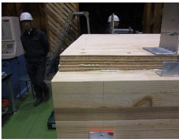
(6) SSP_BS-2 フランジのローリングシアー 破壊
