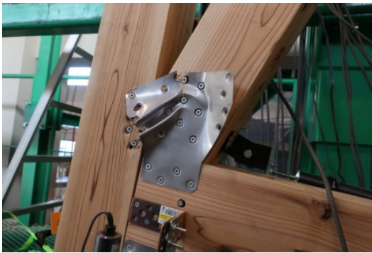
(a) 中間横架材引張筋かい金物の破断 (NCHD-1)
