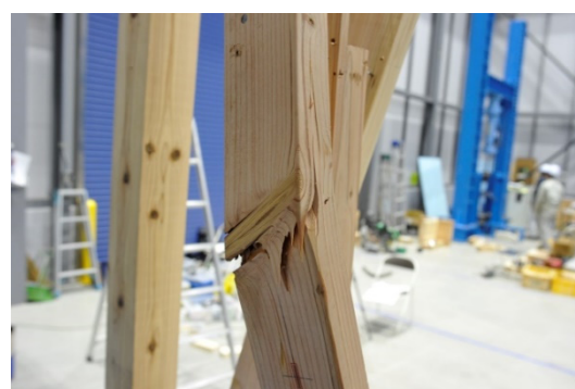
(d) 圧縮側筋かいの座屈破壊 (LS-3)
