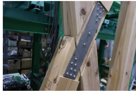
(b) 筋かい交差部の回転変形によるせん断割裂破壊 (NCHD-2)
