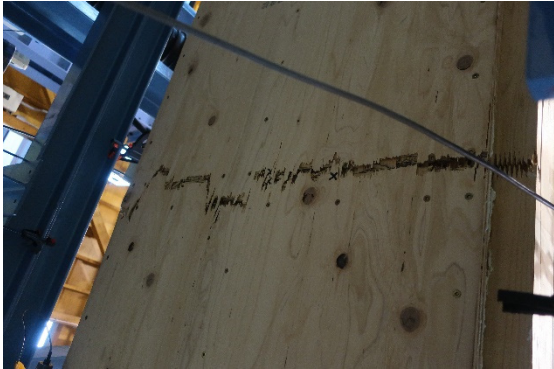
(a) 下フランジの引張曲げ破壊 1
