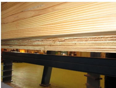
(7) SSP_BS-3 フランジの引張曲げ破壊
