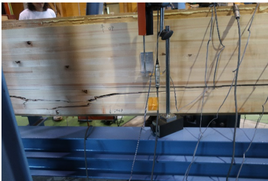
(c) ウェブの曲げ破壊
