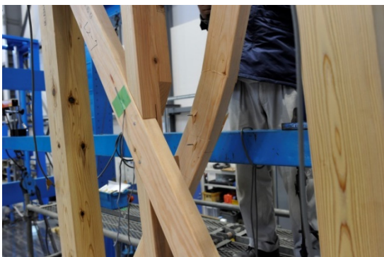
(c) 上段圧縮側筋かいの座屈破壊 (LD-2)
