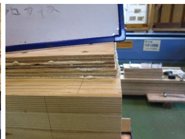
(9) SSP_BS-3 フランジのローリングシアー 破壊
