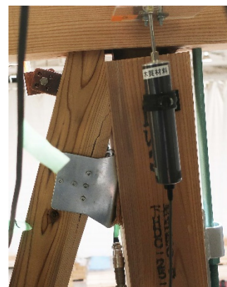
(c) 上段圧縮筋かい上端金物の 変形 (RCHD-2)
