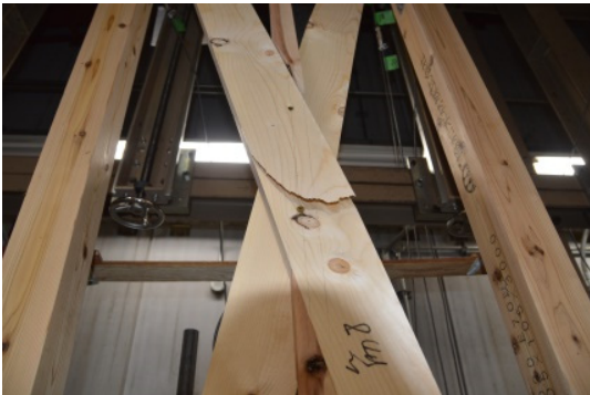
(a) 筋かいの引張り曲げ破壊 (NLS-1)
