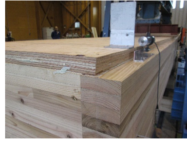
(3) SSP_BS-1 フランジのローリングシアー 破壊
