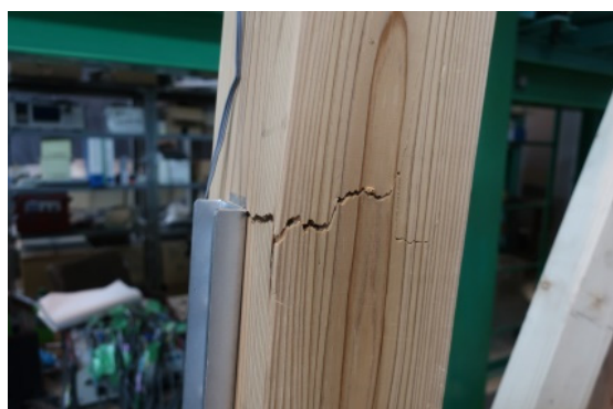
(c) 柱HD 部の引張り曲げ破壊 (NHD-3)
