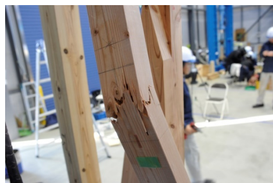
(b) 圧縮側筋かいの座屈破壊 (LS-2)
