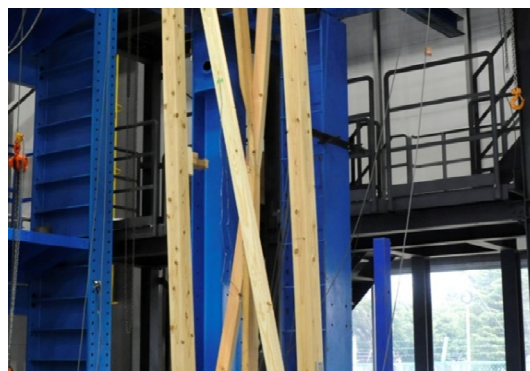
(b) 圧縮側筋かいの座屈変形 (HS-2)
