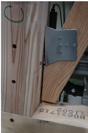
(a) 引張筋かい下端金物の変形 (RHD-2)
