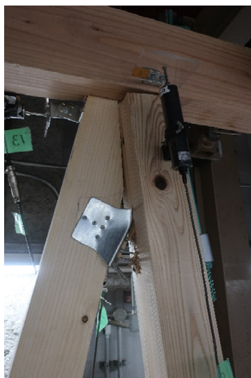
(b) 圧縮筋側の上端金物 接合ビスの引き抜け (RLS-1)
