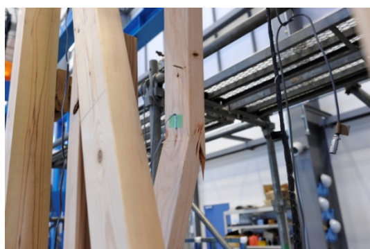
(a) 圧縮側筋かいの座屈破壊 (LS-1)
