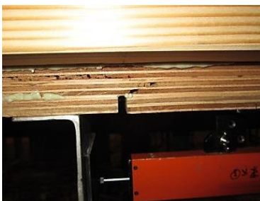
(4) SSP_BS-2 フランジの引張曲げ破壊
