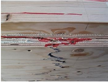
(1) SSP_BS-1 フランジの引張曲げ破壊
