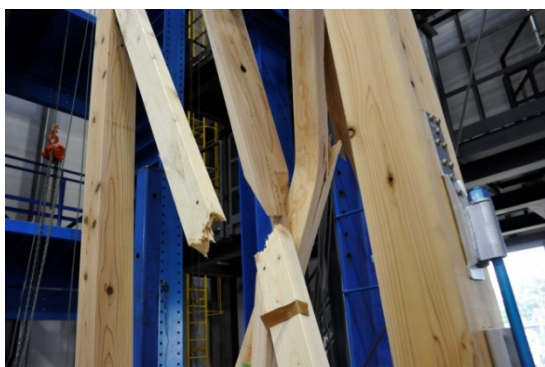
(c) 下段引張側筋かいの引張曲げ破壊 (HD-3)
