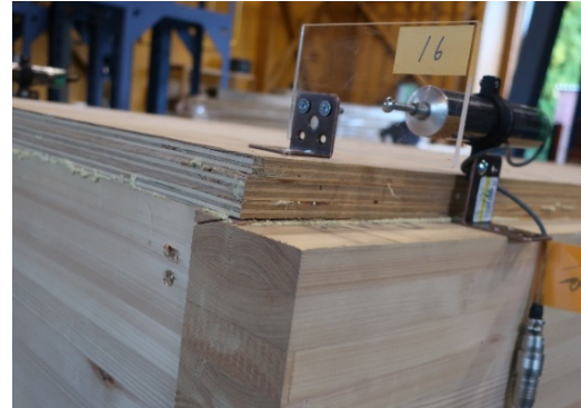
(d) 上フランジのローリングシアー破壊
