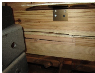
(5) SSP_BS-2 ウェブの曲げ破壊
