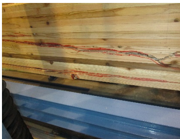
(8) SSP_BS-3 ウェブの曲げ破壊
