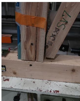
(a) 下段引張筋かい取付部の 柱脚の割裂 (RCHD-2)
