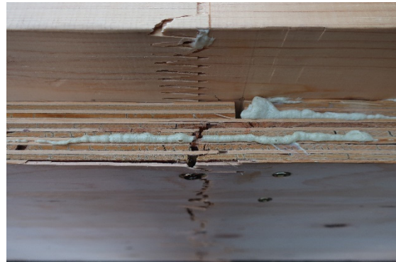
(b) 下フランジの引張曲げ破壊 2
