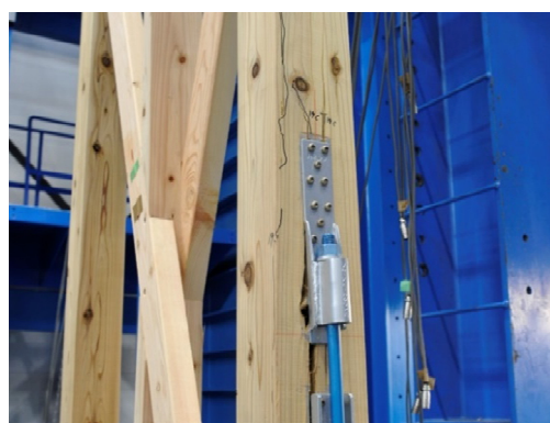
(b) 引張側柱 HD 金物部の引張曲げ破壊 (HD-2)
