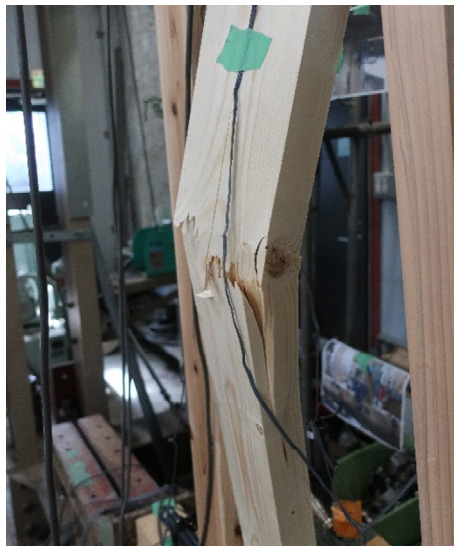
(a) 筋かいの座屈破壊 (NLS-1R)
