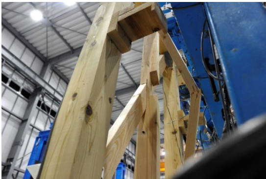
(a) 上段圧縮側筋かいの座屈破壊 (LD-1)
