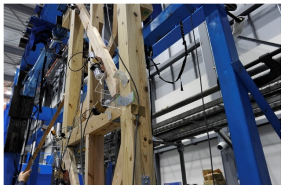
(d) 上段圧縮側筋かいの座屈破壊 (LD-3)
