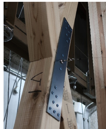
(c) 終局後の筋かいの交差部の 状況 (RCLS-3)
