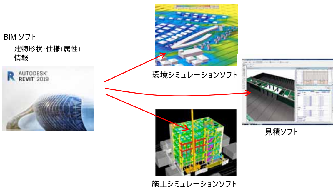
図 6-2-11 BIM とシミュレーション
