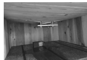
試験体下部の割裂状況
