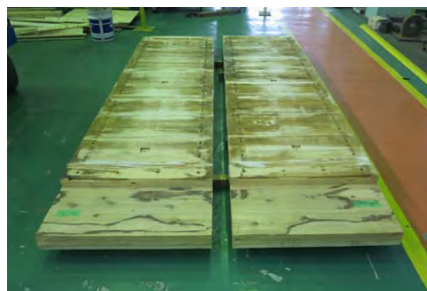
写真 3-17 試験後の木補剛材状況 (鋼板接触面側)
