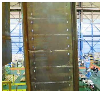
写真 3-16 試験体変形状況 (鋼板部分)
