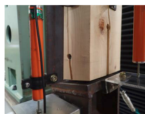
柱に生じた割裂破壊 (補強無し試験体 NRHP-01)
