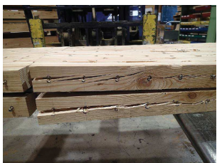
B3 試験体の破壊状況 2
