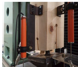
終局時の破壊性状 (RHP-01 試験体)
