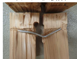
ビスの曲げ変形 (RT-02 試験体)
