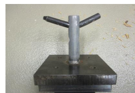
ドリフトピンの曲げ変形 (RT-01 試験体)
