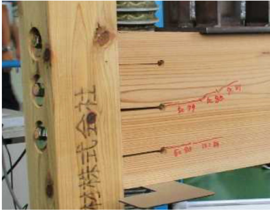
写真 3-12 試験体の破壊性状
