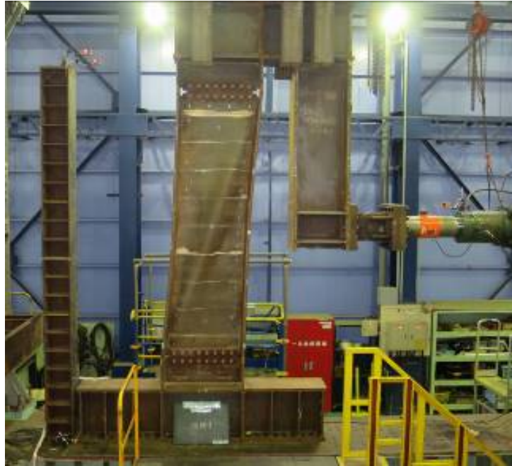
写真 3-15 無補剛試験の変形状況
