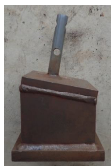
写真 3-8 試験に用いた接合金物
