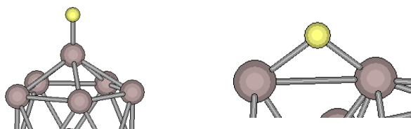
図 3.4.1 Al-H 結合 (左) と Al-H-Al 結合 (右) の例
