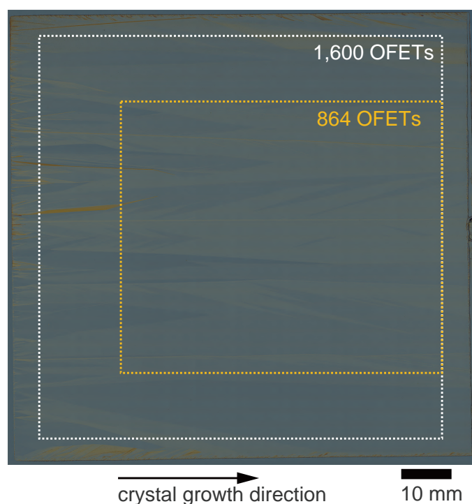
図 2.18 90 mm×90 mm にわたって製膜した C 9 -DNBDT-NW 結晶薄膜の共焦点顕微鏡像. 塗布方向は写真中の左から右方向に相当する. 白と黄色の点線で囲まれたエリアがそれぞれ図 2.20 で 1,600 素子と 864 素子の OFET アレイを作製した箇所に対応している.
