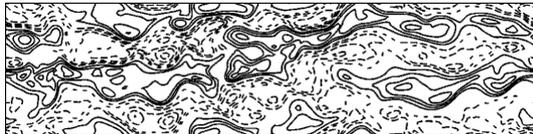
(a) 正磁気シアの flux-tube コード (磁気シア  $s = 0.8$ ) では径方向に細長く伸びたストリーマ構造が維持される [19]。
