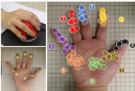
図6 凹み刺激に対する手の接触部位
