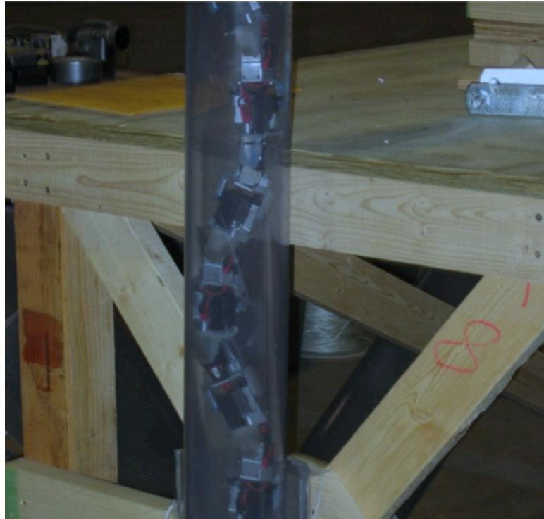
図6.7: 狹所を移動するヘビ型ロボットの例 [143]。モジュールの間にはサーボモータが搭載されている。
