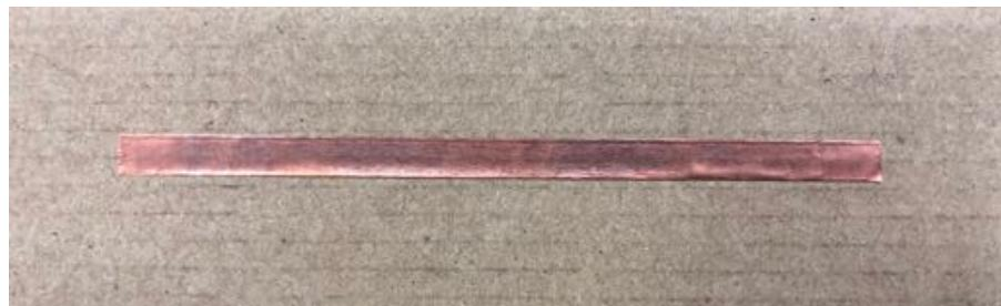
図 3.8: 段ボールの貼付された電気を流す銅テープ。電気を流す銅テープを紙に貼ることで、導線として用いることができる。また、5 m で 6.79 g であった。脚注 15
