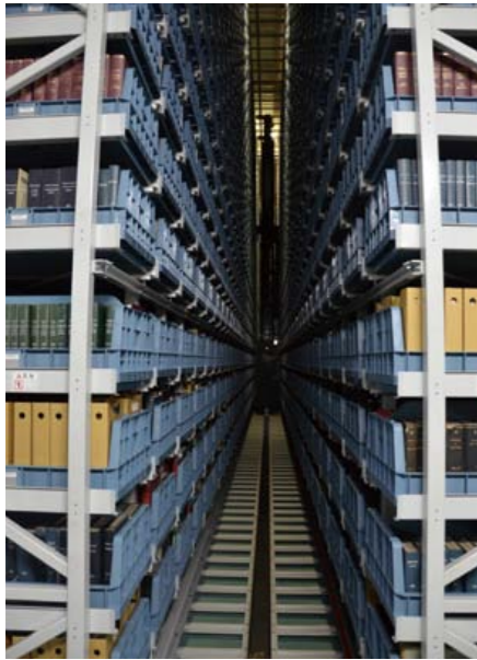
柏図書館自動化書庫の内部。天井まである棚に収められたコンテナをスタックークレーンが取り出す。中央の通路をスタックークレーンが移動する。
