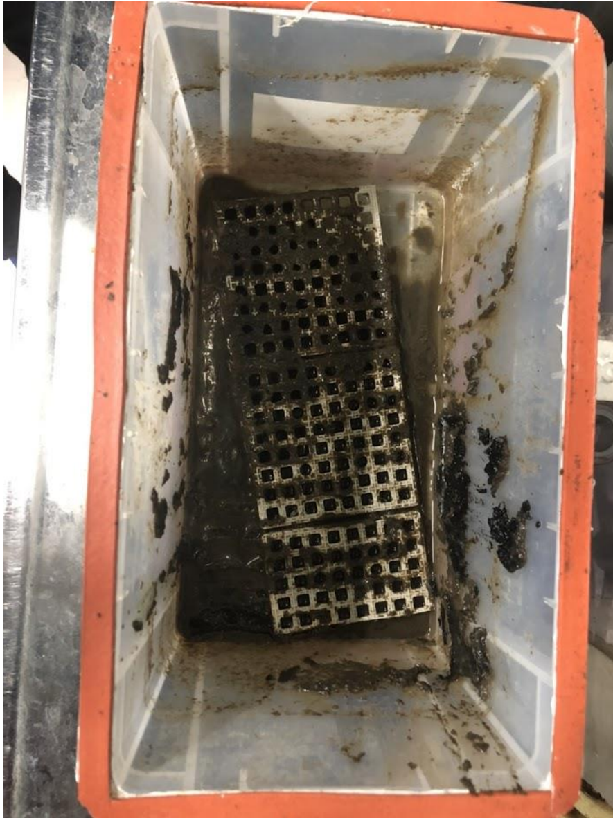
図 4-5 スポンジ槽底部に汚泥が堆積している様子
