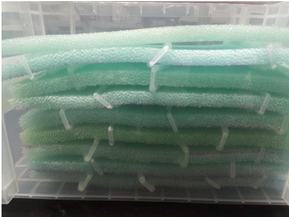
図 横置きスポンジの設置方法
