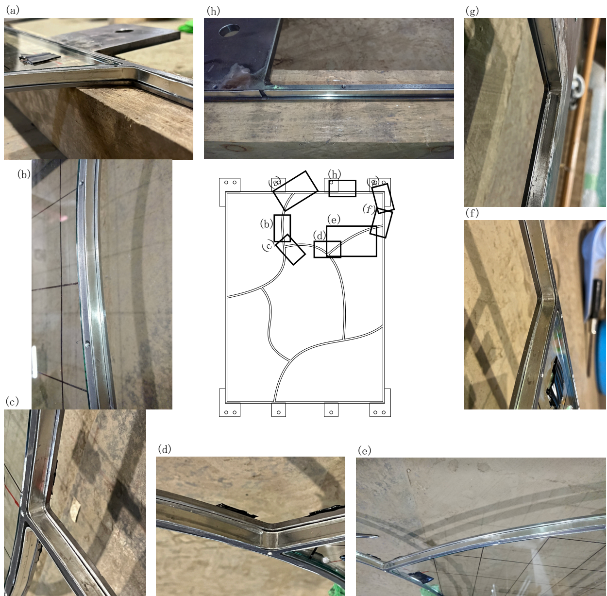
Fig.2.35 曲線U型の錫の圧潰の様子2
