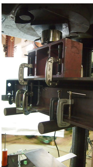
図 4.4: 実験セットアップ：载荷用治具
