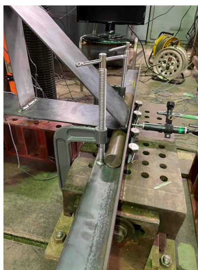
図 4.5: 実験セットアップ：ピン支点治具
