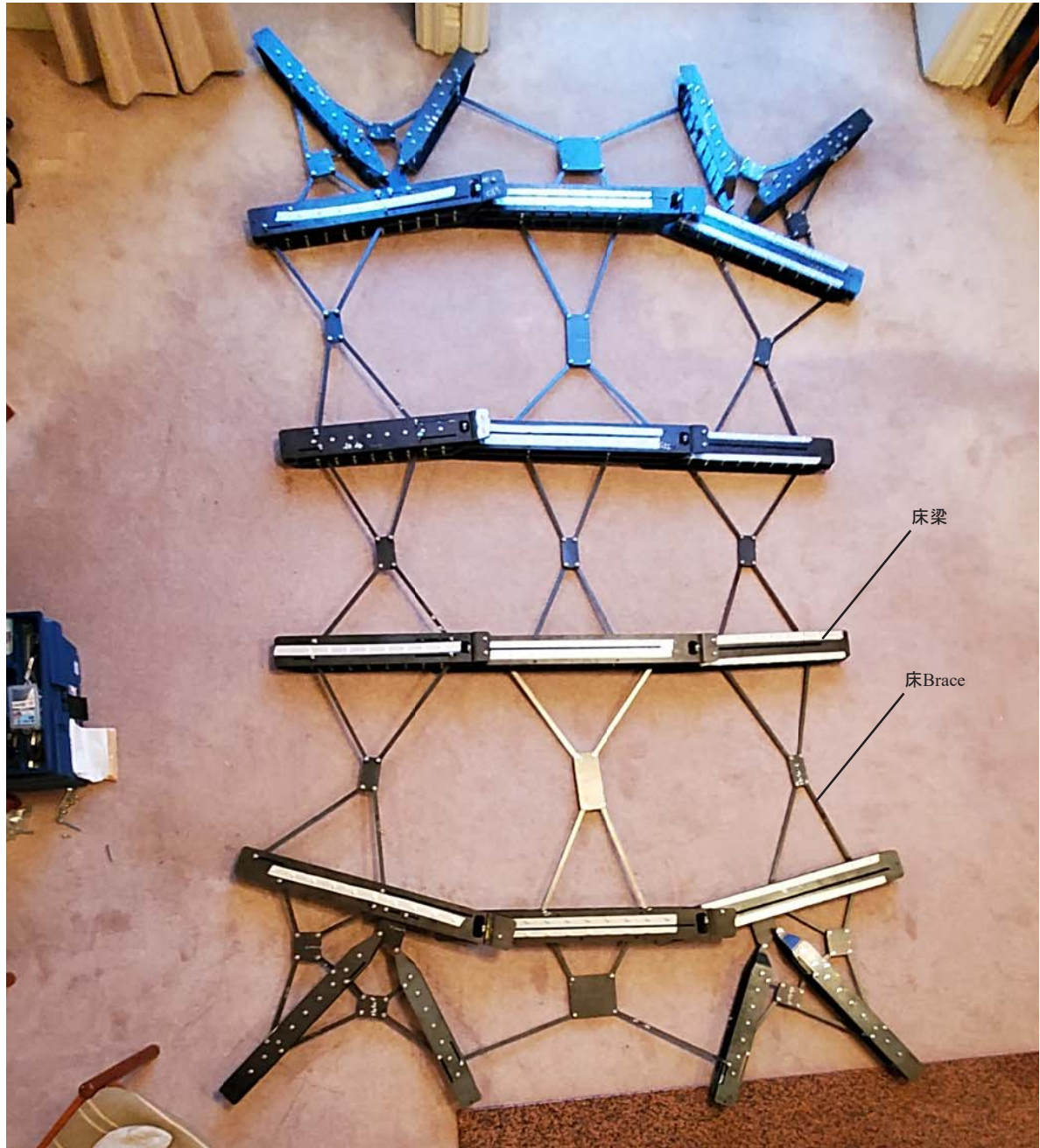
図 5.2 多面体に内蔵される支持部材（撮影：尾形アレックス勇）
