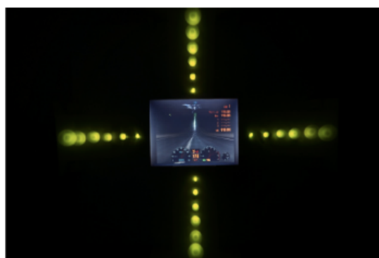
図 2-7:中嶋らの速度感増強システム(周辺情報を削除し,代わりに LED アレイを中心から外側に向かって点灯させて視覚の運動知覚部位を刺激し,迫力感を増強する)[40]
