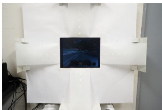
図 2-7:中嶋らの速度感増強システム(周辺情報を削除し,代わりに LED アレイを中心から外側に向かって点灯させて視覚の運動知覚部位を刺激し,迫力感を増強する)[40]
