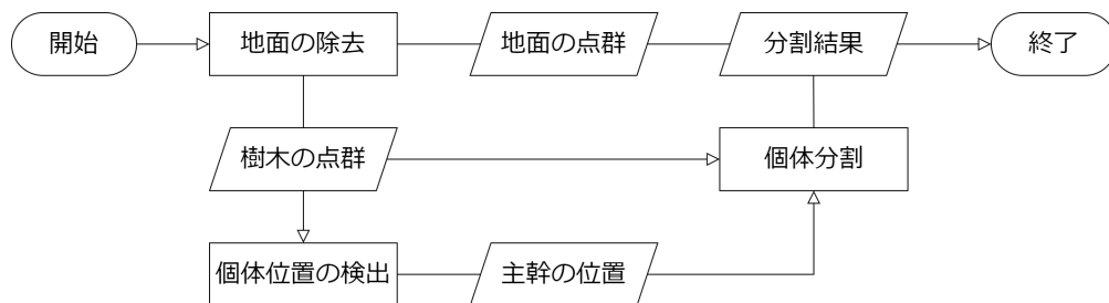
図 3.1: 樹木の点群の個体分割手法の流れ。
