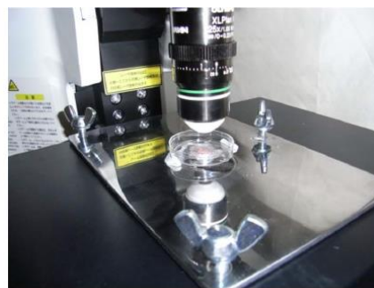
図 1.1 麻酔処置により置き型顕微鏡下に固定されたマウス[10]
