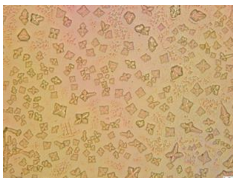
図 5.24 試験中に見られる表面に付着する白色の物質
