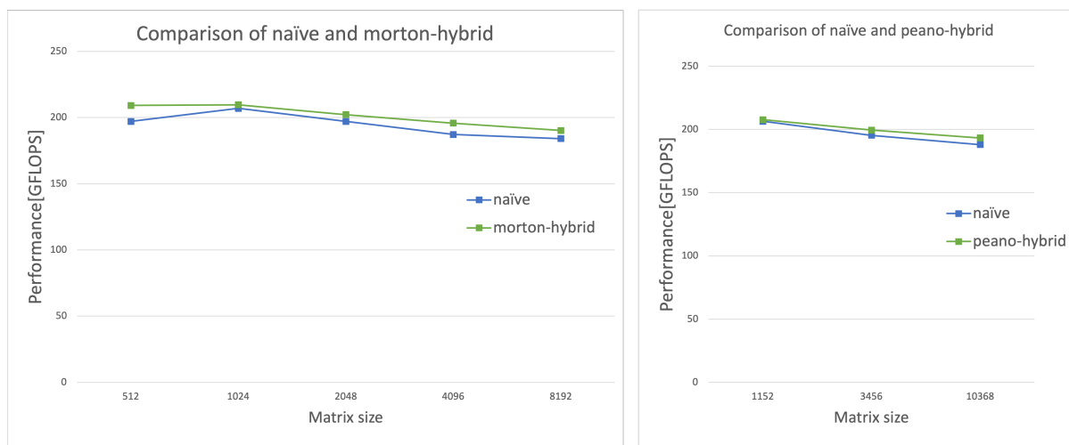
図 3.3: ナイーブな実装とメモリレイアウトを変えた実装の比較
