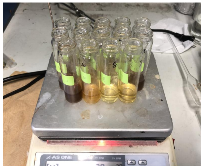
図 2-13 原子吸光分析 液体サンプルの前処理
