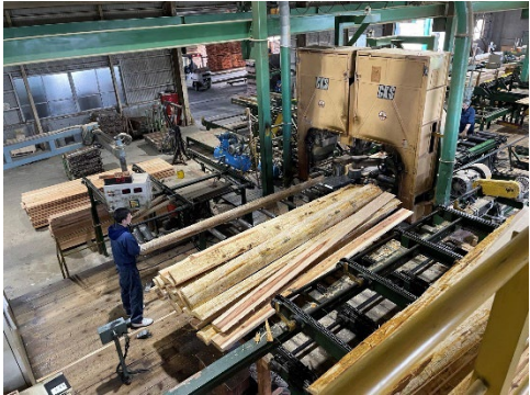
図 4-1-2：製材工場の生産ライン（原木を指定寸
