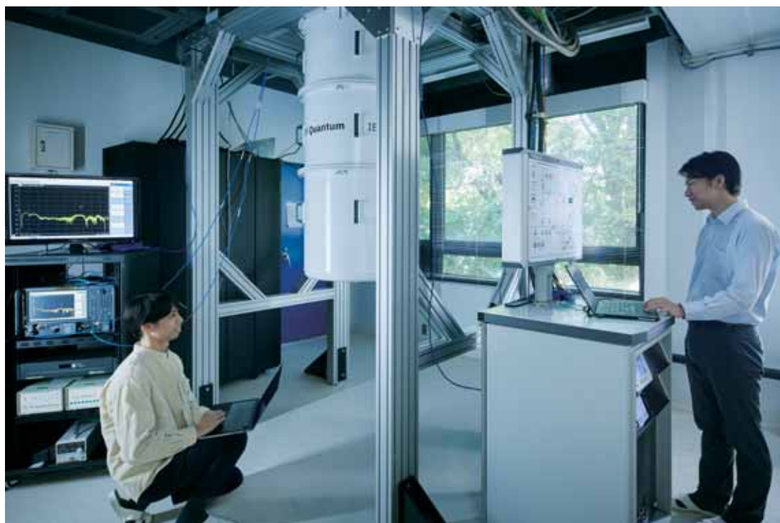
浅野キャンパス内に設置された日本で初めてのIBM量子システム・テストベッド。希釈冷凍機内のIBM製量子チップへマイクロ波を入力して量子ビット状態の制御や非破壊測定を行う。実機の量子コンピュータを用いて、極低温デバイスの性能を調べる企業研究や学生実験にも利用されている
