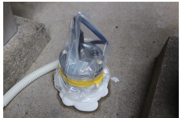
図 2. 石膏を用いた地震計の固定の様子を示す写真。観測点は E.KEJ4（清水観音堂）。
