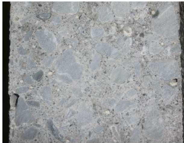
図 3-11 無拘束膨張コンクリートの切断面
