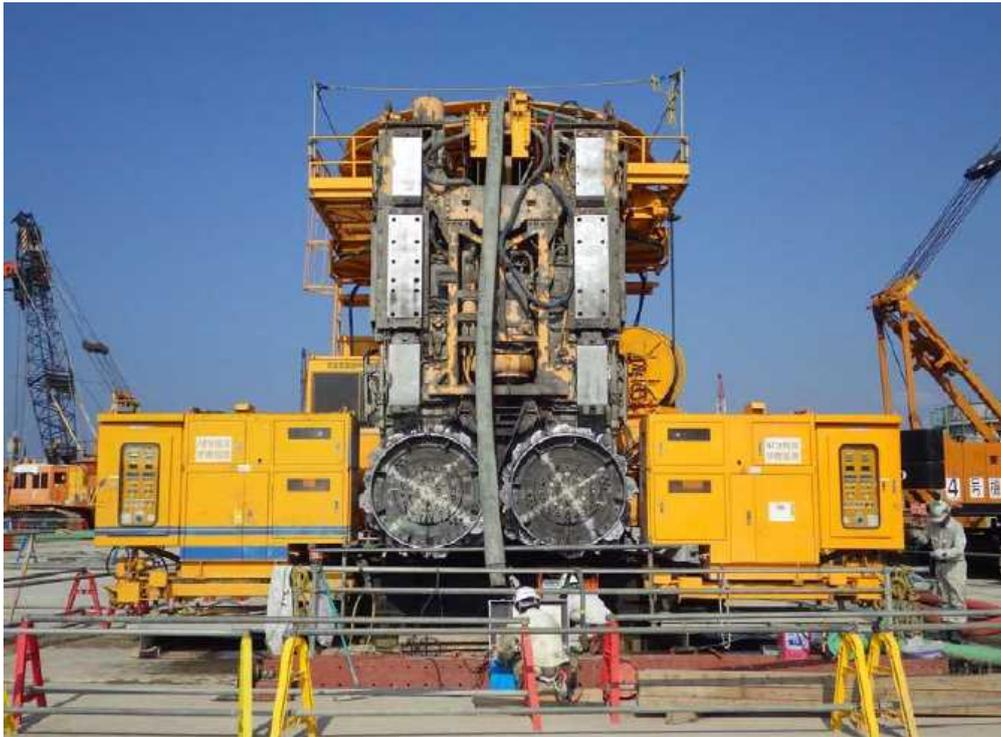
図-D3 連続地中壁工事（カッティングジョイント工法・掘削機）
