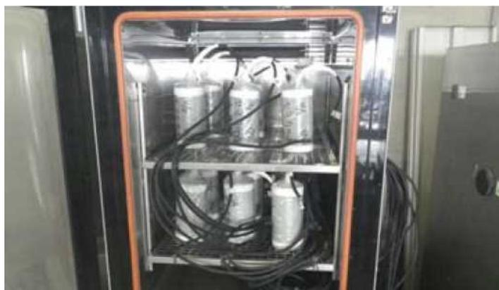
図-A1 熱膨張係数測定試験状況
