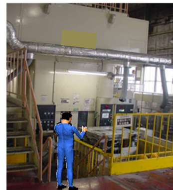
Fig. 4-2 従来の大型プレス鍛造機
