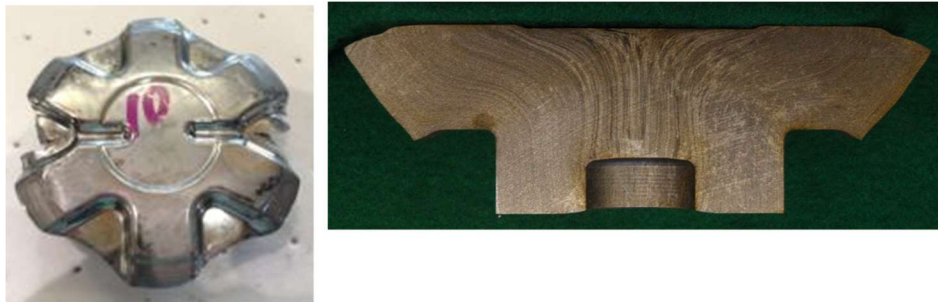
Fig. 4-32 \Delta H=1\text{mm/rev} で成形した結果
