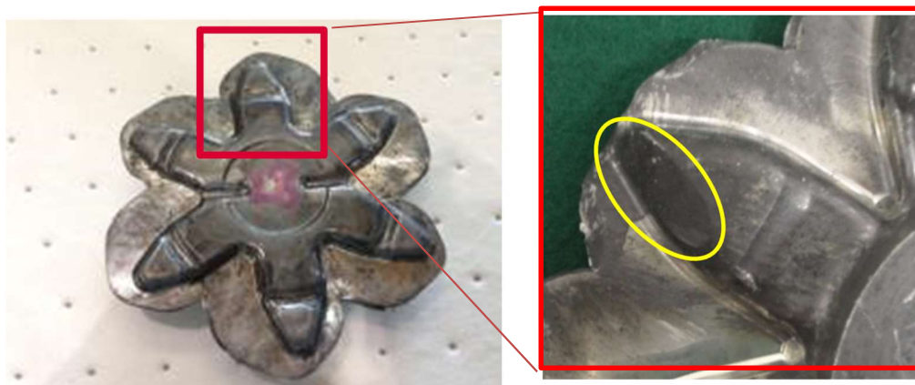
Fig. 4-8 対象製品（バリ除去前）と材料未充填の例
