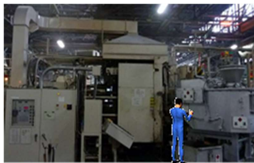
Fig. 1-9 大型ダイカスト加工機の例
