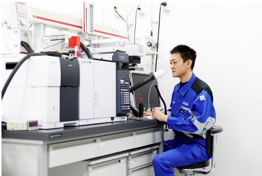
Fig. 1-4. GC-olfactometry システムの概略図と GC-olfactometry による香気評価 効率的に人の嗅覚を用いて、香気成分を探索する手段として GC の検出器として人間の鼻を使用する。MS では検出されないような微量成分も検出されることがあり、重要香気成分を探索する最初のステップとして非常に重要である。
