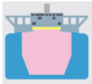
図 3-4 鉄鉱石専用船の断面形状
