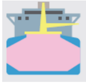
図 3-3 ばら積み船の船殻部の断面形状
