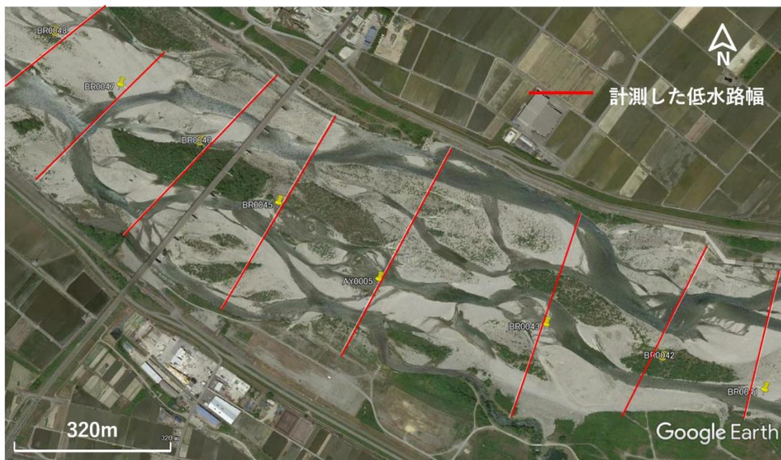
図 2.3.3 Google Earth を用いた低水路幅の特定および計測方法 (Google Earth を編集)
