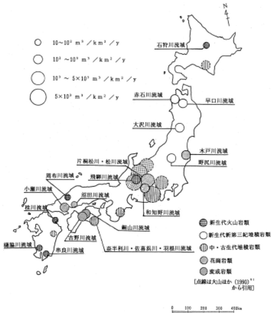
図 1.2.2 地質別崩壊生産土砂量の分布 (井上ら (1992) <sup>13)</sup>)
