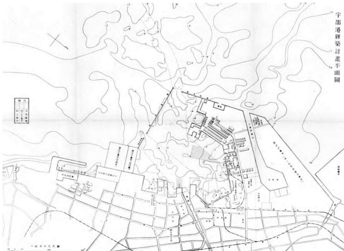
図 4-73 1937 年（昭和 12 年）時点の宇部港修築工事平面図 [495]
