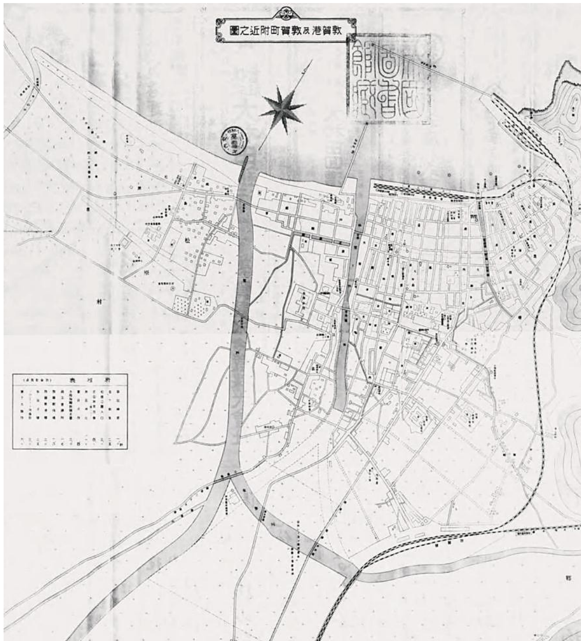
図 4-27 1933 年（昭和 8 年）の敦賀町地図 新設岸壁にも鉄道が引き込まれたことが分かる また港内への堆砂を防ぐため笹の川が西遷された [489]
