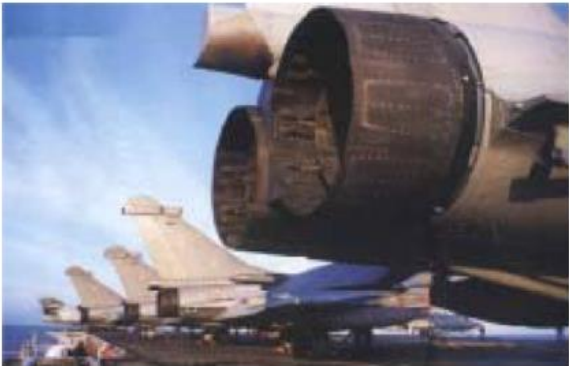
図 1-6 M88 ジェットエンジンの二次フロップ [6]
