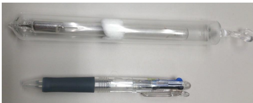
Fig. 2-2 結晶成長前の母合金および封入に用いた石英管
