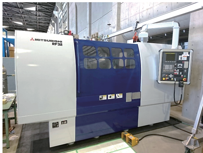
図 5.5 利用した円筒研削盤 RF32 (三菱重工業株式会社製).
