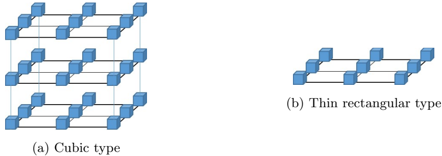
図 5.3: それぞれの条件での観測点の位置：図中の立方体の位置で電場ベクトルを観測する
