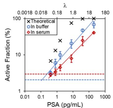
図 5 PSA の検量線 点線はブランクの平均値+3SD, λ は粒子上の平均ターゲット数
