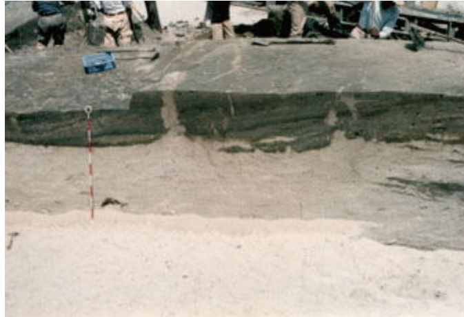
図 2-3 大阪府門真・守口市の西三荘・八雲東遺跡の液状化砂脈跡[6]
