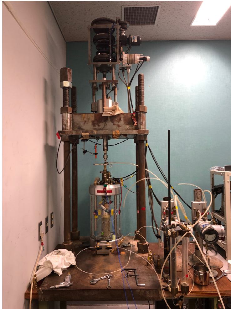
図 3-28 ひずみ制御式三軸試験装置の外観写真
