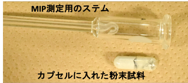
図-4.21 粉末 MIP 用カプセルと測定用ステム
