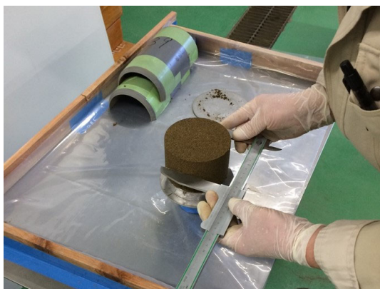
図 4-3-1 密度分布測定状況(試験盛土供試体)
