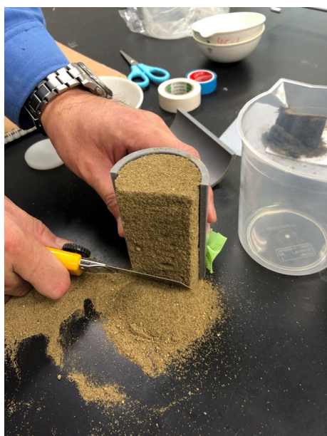
図 A-2-5 供試体切削加工状況
