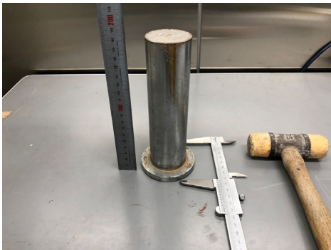
図 3-3-31 湿潤振動締固めに使用した重錘と木づち
