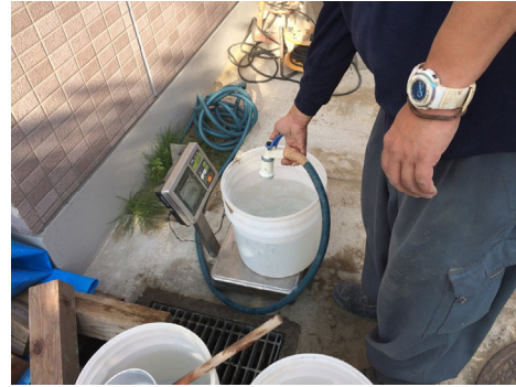
図 3-3-10 加水量調整
