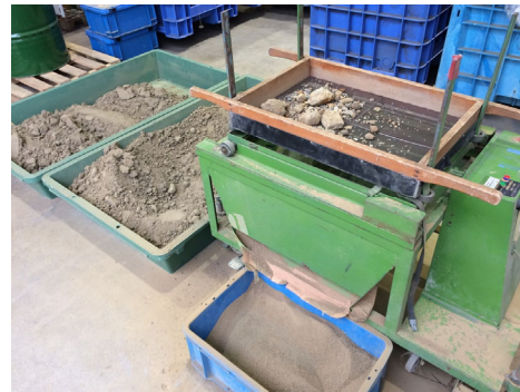
図 3-2-2 炉乾燥後の試料のふるい分け
