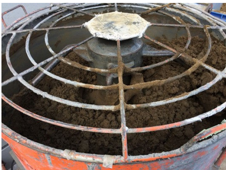
図 3-3-11 試料の攪拌混合
