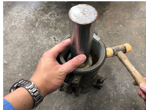
図 3-3-32 鋼製モールド打撃
