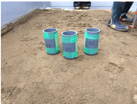
図 3-3-17 試験盛土上へのモールド設置
