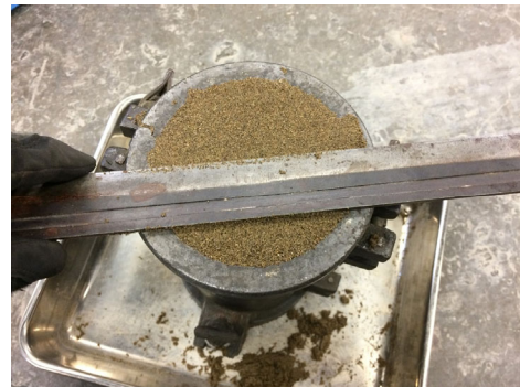
図 3-3-26 供試体上端面整形
