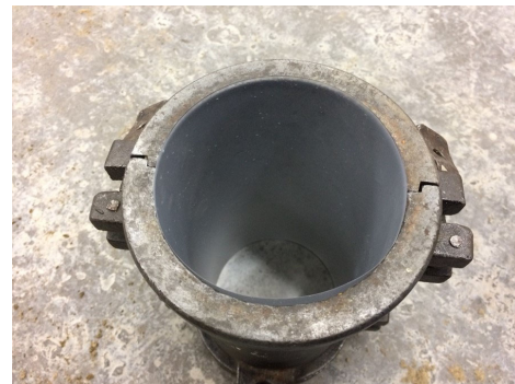
図 3-3-24 モールド内に縁切りフィルム設置
