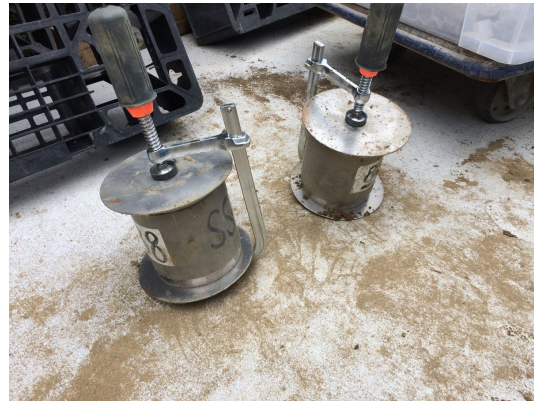
図 4-6-2 試験盛土供試体採取状況
