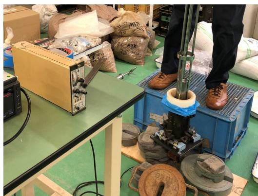
図 4-3-26 撃力測定試験状況
