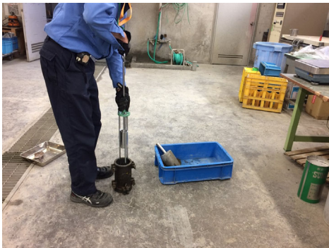
図 3-3-25 突固め法による締め固め
