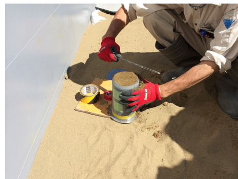
図 3-3-20 供試体端面整形
