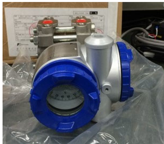
図 3-4-10 飽和供試体の体積変化測定装置
