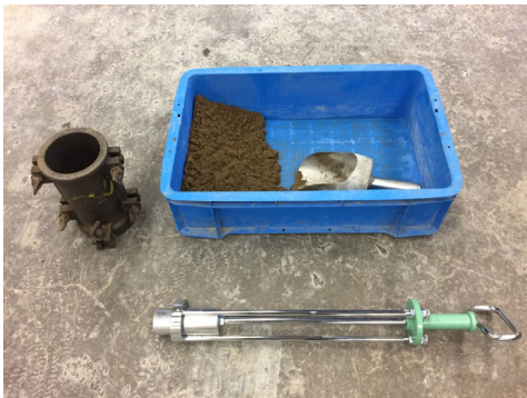
図 3-3-23 加水した試料と締め固め器具
