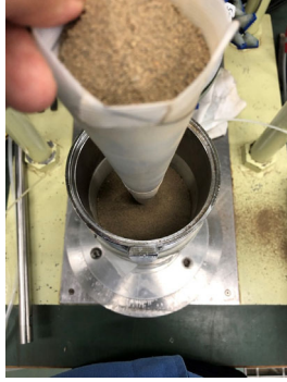
図 3-3-29 試料投入状況
