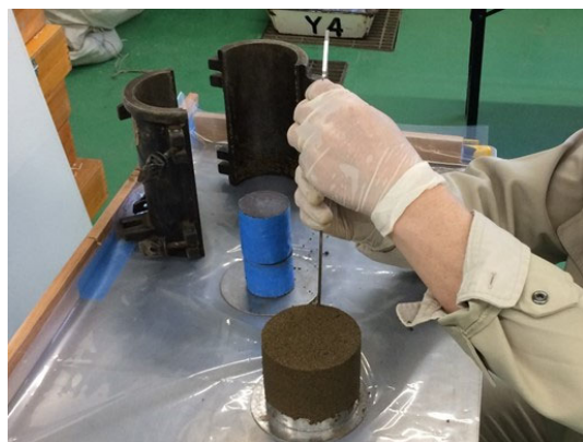
図 4-3-2 密度分布測定状況(室内締固め供試体)
