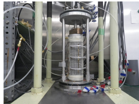
図 3-5-4 局所変位計設置
