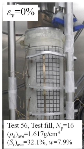
図 6-2-29 三軸圧縮試験後の破壊性状( N_p=16 , 低 S_r 側)
