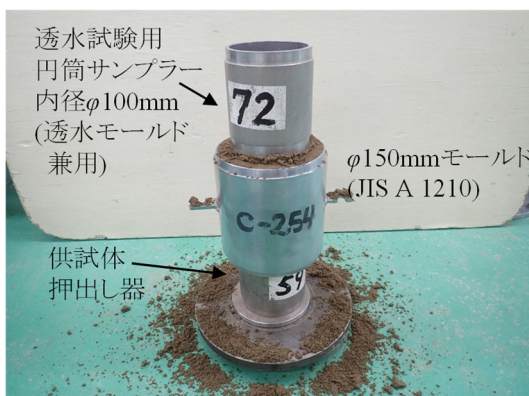
図 4-6-5 室内締め固め供試体のサンプリング状況
