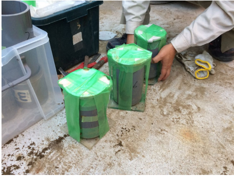
図 3-3-21 試験盛土供試体養生
