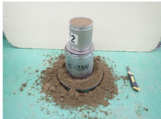
図 4-6-6 サンプリングした室内締め固め供試体
