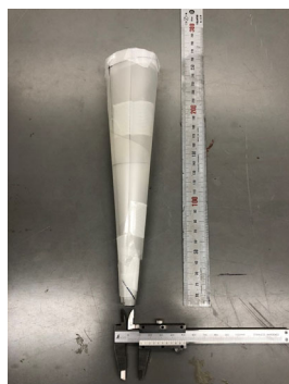
図 3-3-27 空中落下法に使用した漏斗
