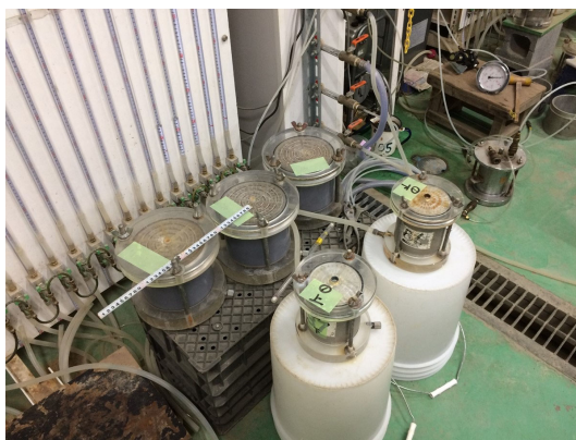
図 4-6-3 透水試験状況(変水位試験)
