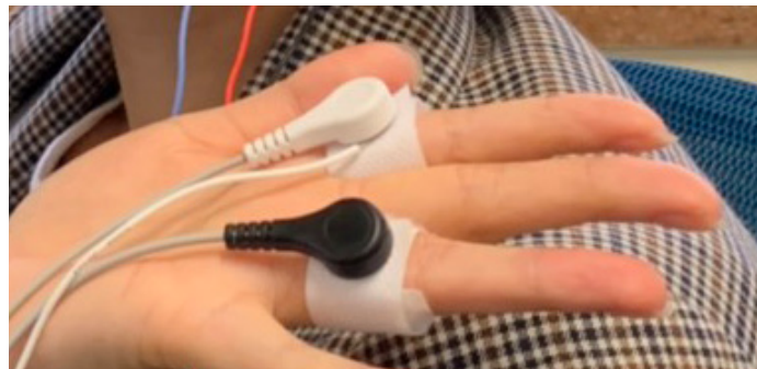
fig.3-10 SCL を計測する電極を装着した様子
