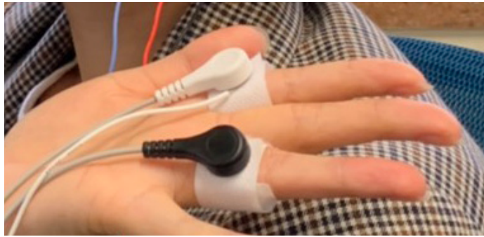
fig.4-12 SCL を計測する電極を装着した様子
