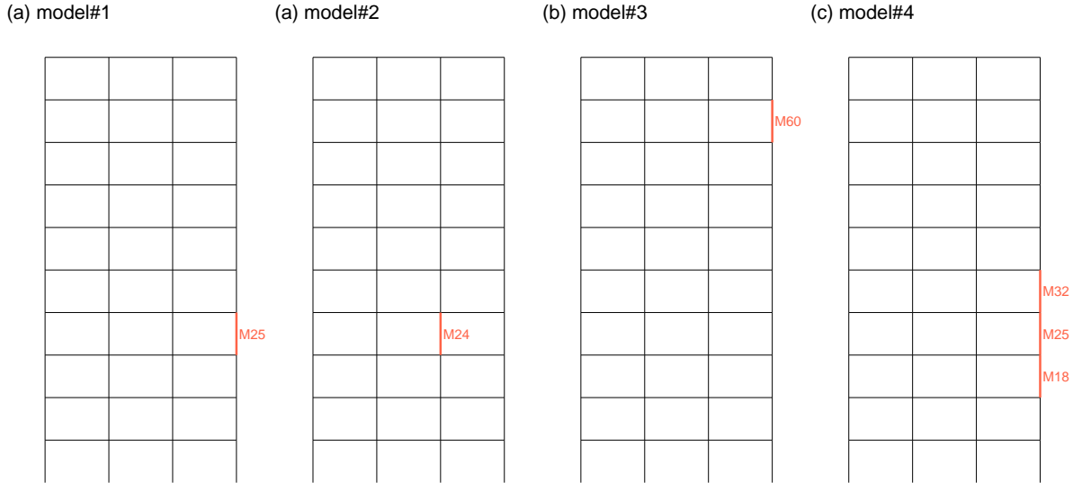
Fig. 5.5 検査対象モデル (model#1-4) における損傷部材位置 (赤線).
