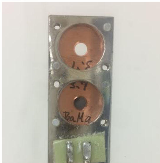
図 3.10 プローブに取り付けたサンプルホルダー。上が真空中の測定のための穴、下が試料である。
