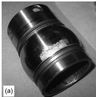
図 2.9 IMS データセットにおける軸受故障後の各部品の外観 (a: 内輪、b: 転動体) [39]
